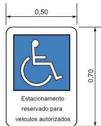
Figura 1 - Sinalização para vaga de veículo
