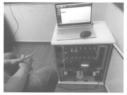
Demonstração da central UTC em execução comunicando com o controlador via protocolo aberto UTMC2, fazendo o controle dos estágios do controlador através dos objetos do protocolo para o Anel **J01011**.
