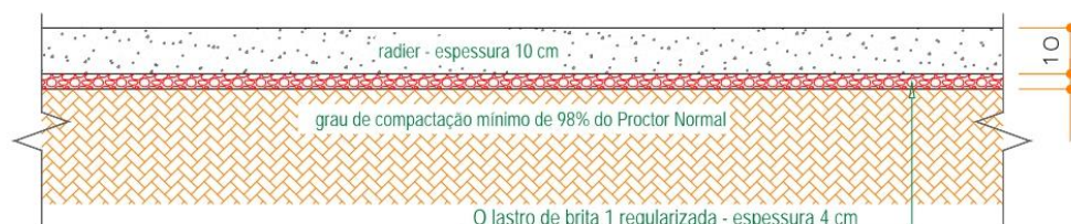
Figura 1 - Corte genérico da seção transversal do conjunto radier /lastro de brita/terreno natural, corte ou aterro.
